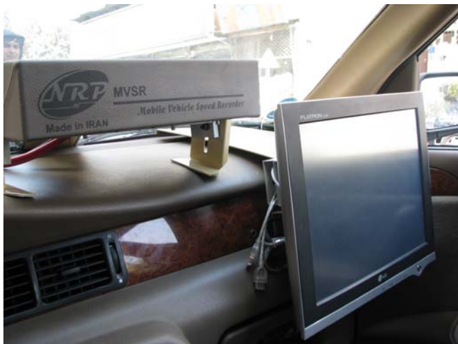
سامانه تصویربرداری دوربینایی قابل نصب بر روی داشبورد خودروی پلیس
