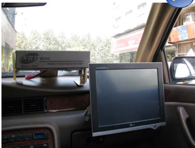
سامانه تصویربرداری دوربینایی قابل نصب بر روی داشبورد خودروی پلیس
